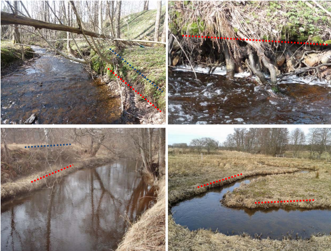
Figur 5-15. Foton som visar nivån vid bankfullflöde (bankfullnivån), markerat med röd linje. Den blå linjen i två av fotona visar nivån som vattnet tidigare haft vid bankfullflöde (vattendragen har skurit sig nedåt och har lägre bankfullnivå än tidigare). Var den nivån legat går att läsa ut från nivån på det tidigare svämplanet (recent terrass). Sista bilden visar aktivt svämplan där således bankfullnivån ligger på samma nivå som svämplanet.
